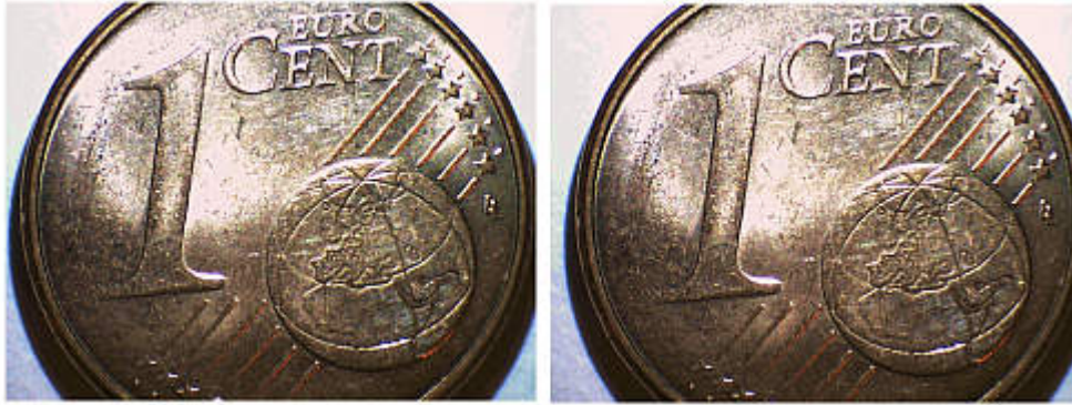
Stereobildpaar einer Centmünze in der Lichtmikroskopie.
