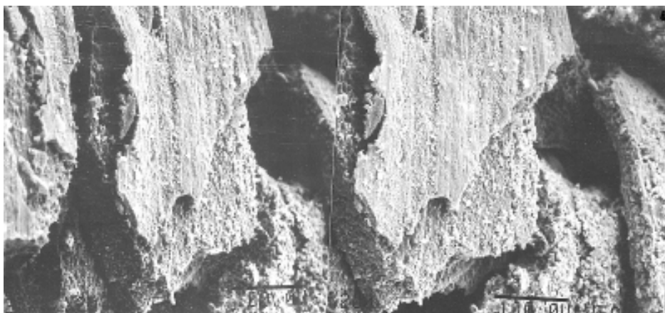
Abrieb einer Zahnradpumpe bei 200facher Vergrößerung
